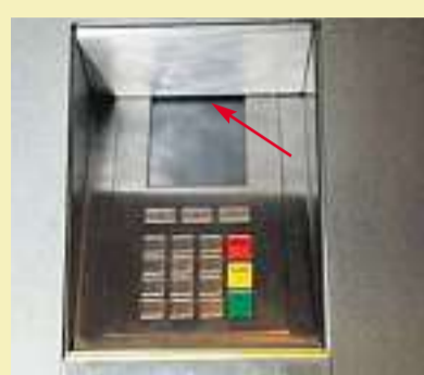
Manipulierter Billettautomat: Eine Minikamera erspäht den PIN-Code. Bild Kapo Luzern
